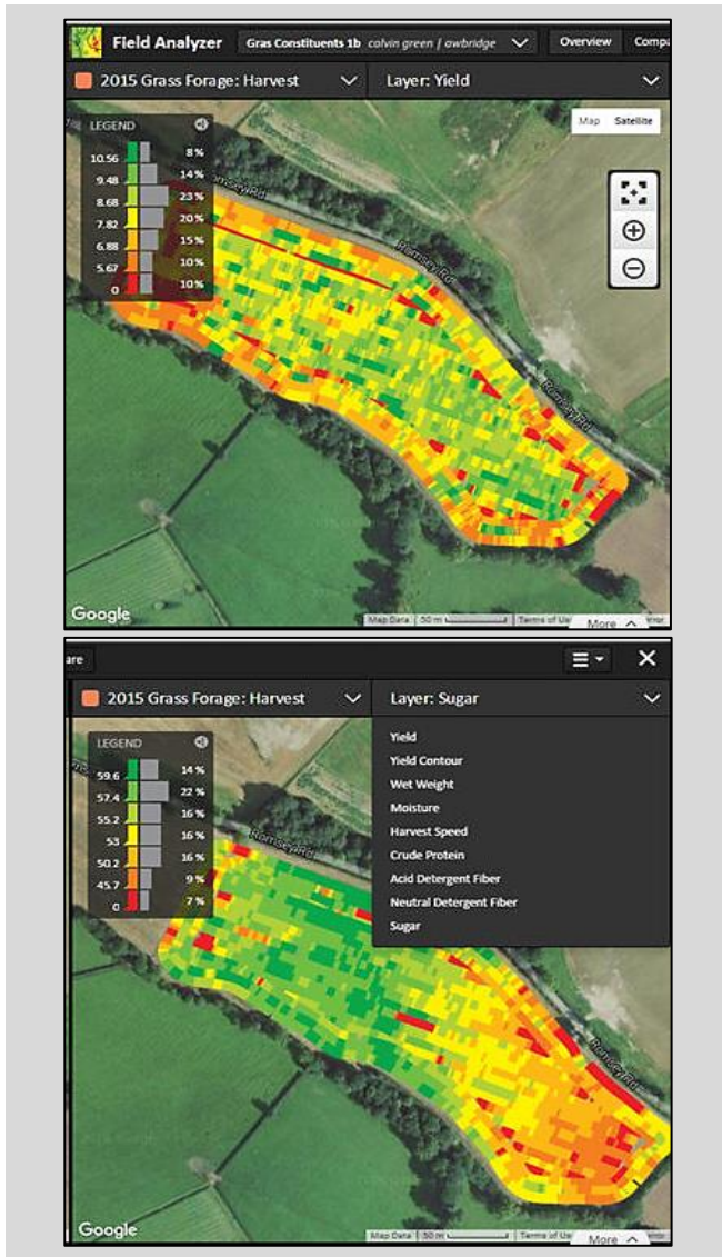
FIGURE 1 : Données récoltées par le dispositif HarvestLab® embarqué dans une ensileuse. Rendement (à gauche) et taux de sucre (à droite).
