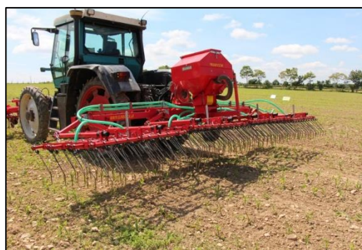
Figure 5 : Herse étrille équipée d'un semoir Einböck
