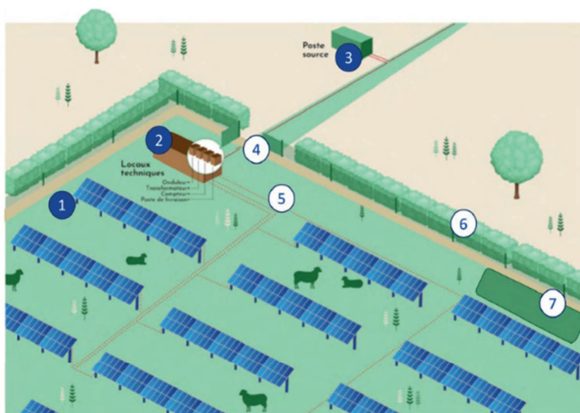
Figure 3 : les différents composants d'une centrale agrivoltaïque (qair, 2023)
