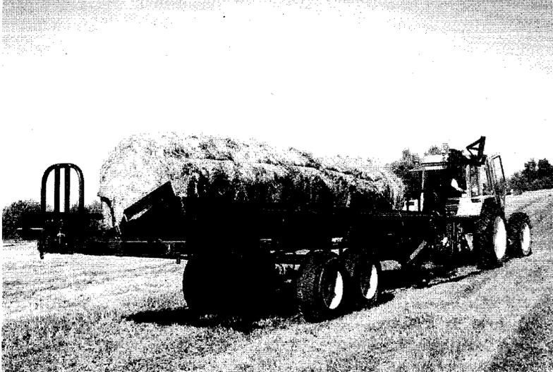
Figure 9 : Autochargeuse pour enrubanneuse en continu.
