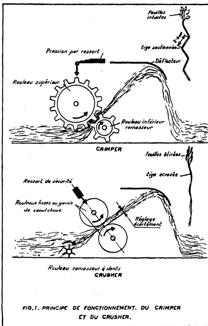
Certains constructeurs ont remédié par la suite à ces défauts en garnissant leurs rouleaux d'un revêtement en caoutchouc, d'autres ont conçu un appareil différent, plus simple, plus léger et moins cher, appelé *Crimper*, dont le but est de plier simplement les tiges à des intervalles de 3 à 4 cm environ, de façon à préserver les feuilles et à « feutrer » l'andain pour faciliter son aération.
