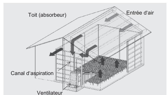
FIGURE 3 : Schéma d'une installation avec séchage solaire.
