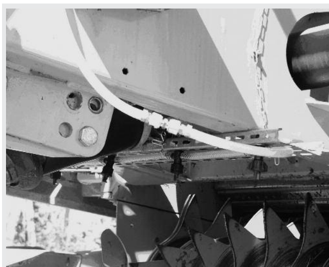
PHOTO 1 : Buses d'injection situées sur la presse.
