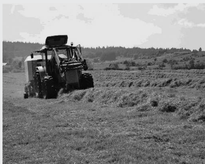
PHOTO 2 : Stockage de l'acide à l'avant du tracteur (le bidon sert aussi de contrepoids).
