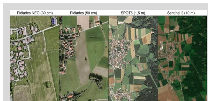
FIGURE 1 : Illustration de la variabilité inter-parcellaire et intra-parcellaire en fonction de la résolution spatiale (source Airbus Defence and Space).
