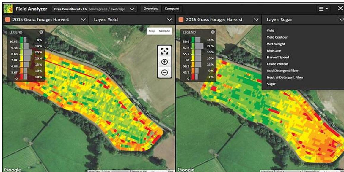
FIGURE 1 – Données récoltées par le dispositif HarvestLab® embarqué dans une ensileuse. Rendement (à gauche) et taux de sucre (à droite).
