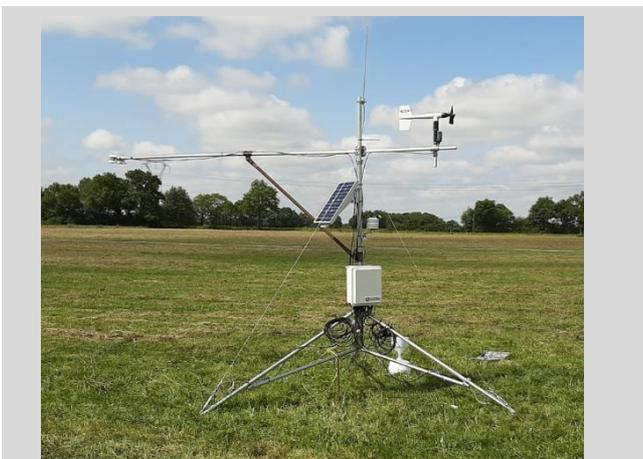
FIGURE 2 : Un albedomètre, ferme expérimentale de Derval (44).
