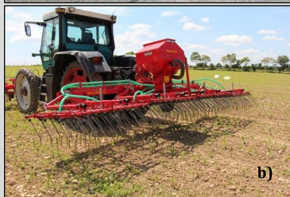
FIGURE 4 : Outil à dent Horsch (a) et Herse étrille équipée d'un semoir Einböck (b)
