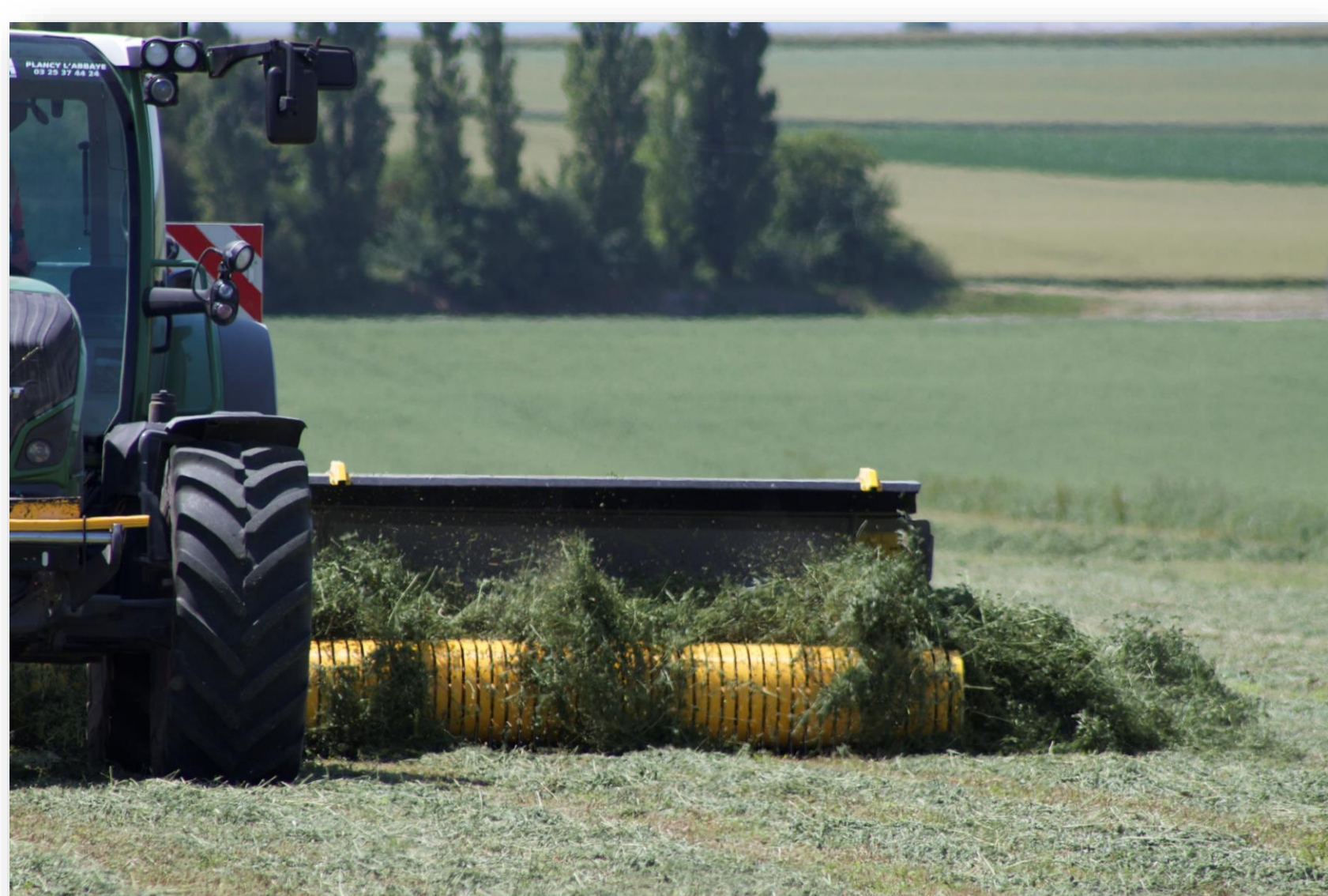
Andaineur à tapis, La Coopération Agricole
