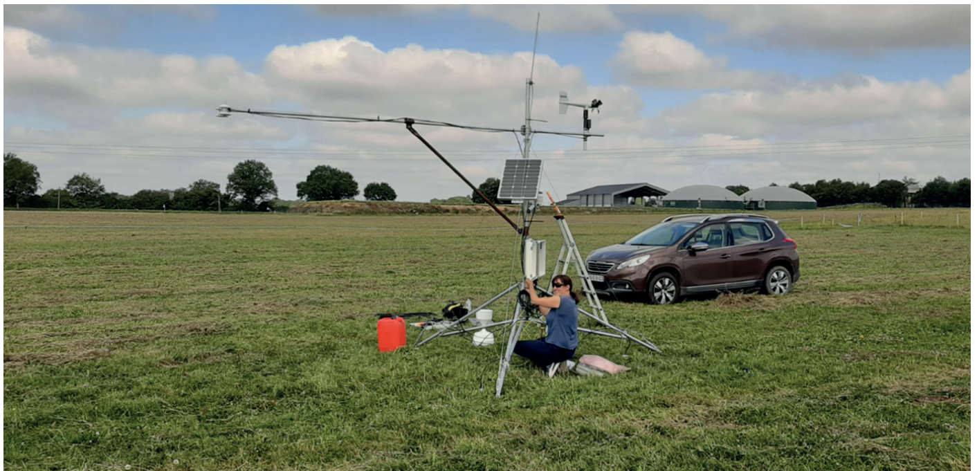
Figure 1 : Un albedomètre installé dans une prairie pour les expérimentations (Crédit Photo : Mischler) Figure 1 : An albedometer installed in a grassland for experimentation
